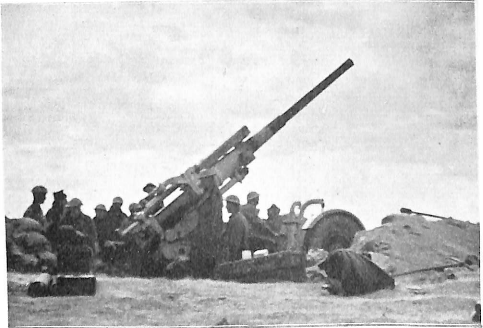
شكل ٤١ - مدفع بريطاني ثقيل مضاد للطائرات عيار ٣٧ بوصة
